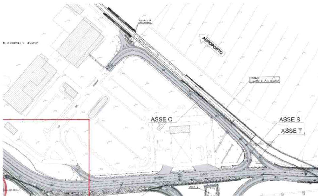
Figura 5 – Stralcio della tavola del progetto esecutivo dello Svincolo Terminale di Peretola redatto da ASPI con evidenza del nuovo braccetto viario di accesso all'Aeroporto Amerigo Vespucci (asse T in accesso, asse S in uscita ed asse O verso l'aeroporto)
